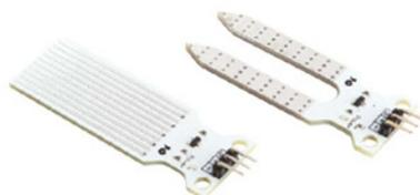
**Détecteur d'humidité du sol & détecteur de niveau d'eau**
